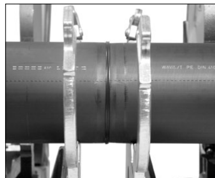
Správně vytvořený svarový spoj na tupo
