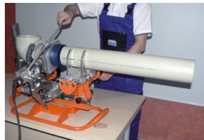
Upnutí do přípravku a vycentrování, poté nahřívání
