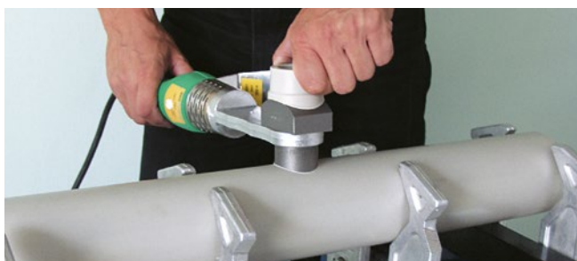
3/ Navařovací sedlo nasuneme na nástavec tak, aby na sebe navazovaly rysky na sedle a nástavci. Prohřejeme otvor i navařovací sedlo. Doba prohřívání je v tabulce.
