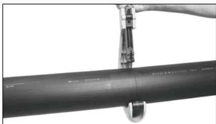
Řez potrubí ruční rotační rezačkou
