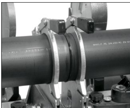
Chladnutí svařeného spoje
