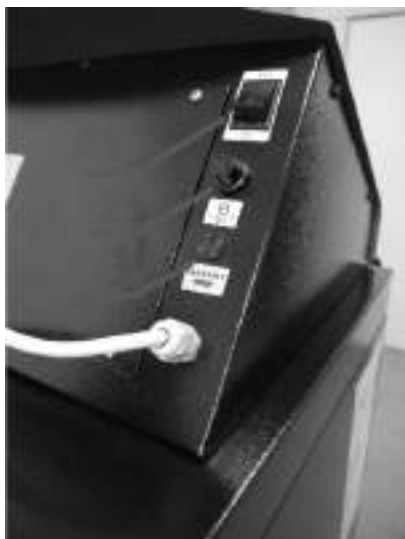
Obr. 17 1 – hlavní vypínač, 2 – havarijní termostat, 3 – pojistka (F6,3A)
