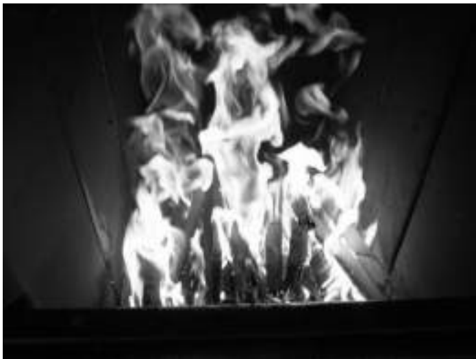
Obr. 11 Dostatečně rozhořená základní vrstva
